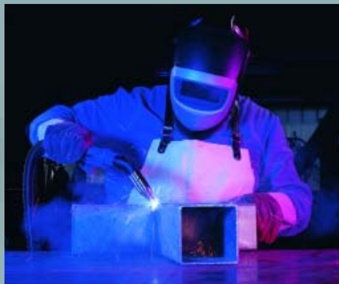
RAB Plus с функцией дымоотсоса
