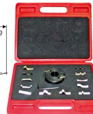
Обработка большинства деталей сложных профилей выполняется блоком из 2-5 закрепляемых на оправке одинарных фрез. Блок одинарных фрез можно заменить фрезерной головкой с набором прямых и профильных ножей.
