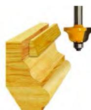
3. Применение кромочной калевочной фрезы арт. 9263. Перед применением кромочной калевочной фрезы для уменьшения нагрузки на фрезерную машину необходимо отпилить часть заготовки, как показано на рисунке, с помощью круглопильного станка (модель «Корвет-11») и повернуть заготовку на 180°.
