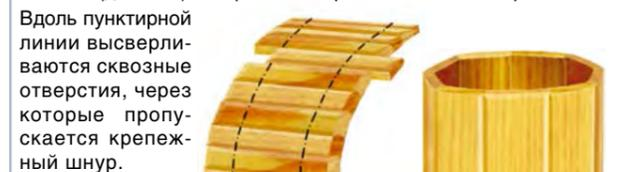
Вдоль пунктирной линии высверливаются сквозные отверстия, через которые пропускается крепежный шнур.
