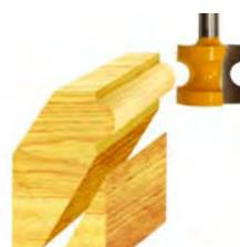
2. Применение кромочной полустержневой фрезы арт. 9310. Перед применением кромочной калевочной фрезы для уменьшения нагрузки на фрезерную машину необходимо отпилить часть заготовки, как показано на рисунке, с помощью круглопильного станка (модель «Корвет-11») и повернуть заготовку на 180°.
