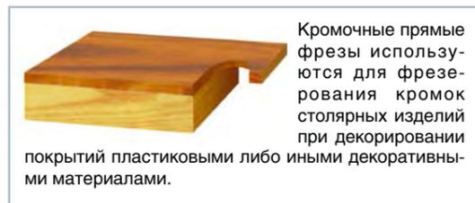
Кромочные прямые фрезы используются для фрезерования кромок столярных изделий при декорировании покрытий пластиковыми либо иными декоративными материалами.
