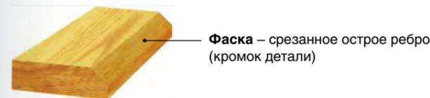
**Фаска** – срезанное острое ребро (кромки детали)
