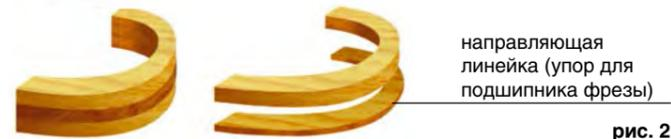
направляющая линейка (упор для подшипника фрезы) **рис. 2**
