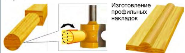
Изготовление деревянных стержней
