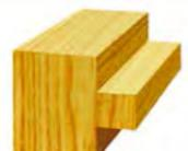
Получение шипа при двухстороннем фрезеровании
