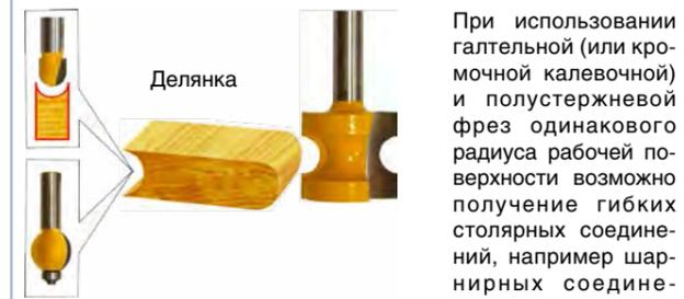
При использовании галтельной (или кромочной калевочной) и полустержневой фрез одинакового радиуса рабочей поверхности возможно получение гибких столярных соединений, например шарнирных соединений для гибких скользящих шторок-дверц, а также объемных изделий любой конфигурации с необходимым количеством клепок (делянок), ширина которых может быть различной.
