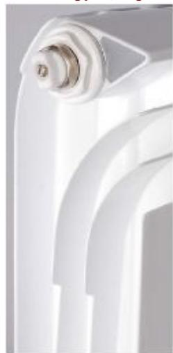
Секции радиатора выполнены из высокопрочного алюминиевого сплава ADC12 по норме JIS H5302 (примерно соответствует российской марке АК12М2 по ГОСТ 15183-93) методом литья под давлением.
