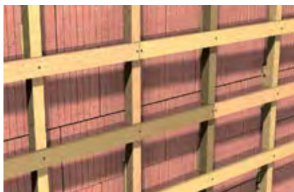
Крепление фасадных подконструкций
