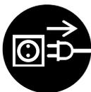
**ВНИМАНИЕ:** При выполнении любых работ с полотном пилы или пильной цепью следует обязательно одевать защитные перчатки и выдернуть сетевой штекер из розетки.
