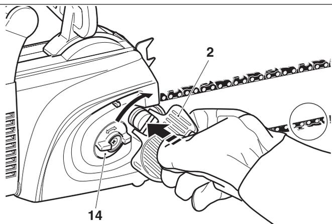
Отпустить быстрый зажим кожуха цепной звездочки (2) (разгрузить его) так, чтобы он свободно поворачивался, затем захлопнуть его, как показано на рисунке.
