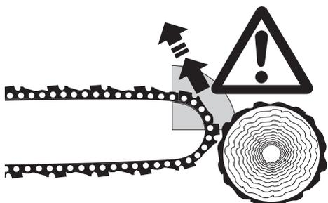
Цепные пилы серийно оснащены цепным тормозом, срабатывающим при достижении определённого ускорения. В случае рикошета, возникающего при прикосновении носовой частью полотна цепи к дереву (см. раздел ”Указания по технике безопасности” на стр. 7), цепной тормоз срабатывает при достаточно сильном отбрасывании из-за инерционности массы.
