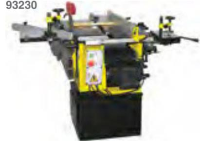
Функции станка: распиловка, строгание, рейсмус, сверление, фрезерование насадными и концевыми фрезами. Фрезерная головка и фрезерный патрон в комплекте. В режиме сверления заготовка крепится на рабочий стол, перемещаемый по трем осям. При распиловке используется подвижная каретка с прижимной струбциной и транспортным упором. Отключаемая автоподача рейсмуса. Нижний рабочий стол имеет два удлинителя. Предусмотрено подключение пылесоса.
