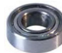
Радиальные шариковые подшипники закрытого типа повышенного класса точности устанавливаются на кромочные, пазо-шпоровые, комбинированные и другие типы фрез. Предназначены для направления движения фрезы вдоль кромки обрабатываемой заготовки для обеспечения равномерной обработки кромки. Обеспечивают плавное движение фрезы по кромке и предохраняют кромку от прижогов.
