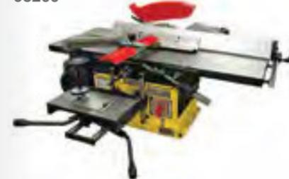
Функции станка: распиловка, строгание, сверление. В режиме сверления заготовка крепится на рабочий стол, перемещаемый по трем осям. При распиловке используется подвижная каретка с прижимной струбциной и транспортным упором. Предусмотрено подключение пылесоса.
