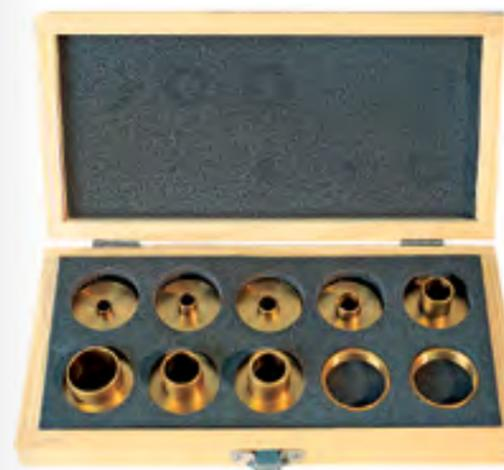
Копировальные втулки позволяют обрабатывать криволинейные кромки параллельно образцу. Также с их помощью можно выполнять соединения типа «ласточкин хвост», ступенчатую обработку, выточку букв и цифр. В комплект входит 2 стопорные гайки и 8 копировальных втулок. Копировальная втулка вставляется в отверстие станины фрезера и фиксируется контргайкой.
