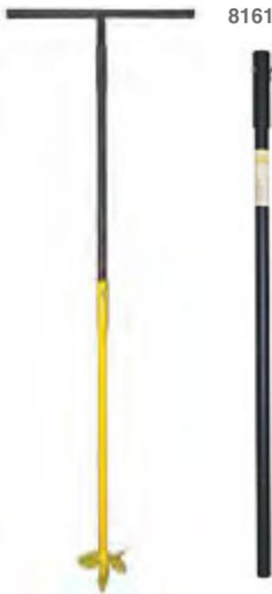
Буры универсальные садово-строительные предназначены для бурения грунта любого типа с целью установки столбов, заливки фундаментных опор, для посадки растений и т.д. Глубина бурения до 1,6 м. Возможно бурение неглубоких скважин на воду до 11 м с использованием дополнительных удлинителей.
