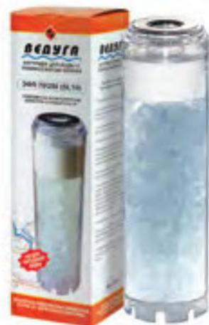
**Картридж для воды 10" полифосфат** (арт. 69361) предназначен для умягчения воды, применяемой в санитарно-технических целях. Защищает трубы, нагревательные элементы стиральных и посудомоечных машин, бойлеров, газовых колонок от коррозии и образования известковых отложений. Содержит кристаллический полифосфат натрия. Срок службы около 1 года (зависит от содержания солей жесткости в исходной воде). После истечения срока службы картридж подлежит замене или загрузке новой порции полифосфата натрия.
