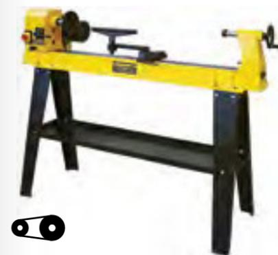
Плавная регулировка скорости вращения шпинделя с помощью вариатора. Возможность установки копировального устройства. Передняя бабка поворачивается для обработки больших диаметров не над станиной. Подставка в комплекте.
