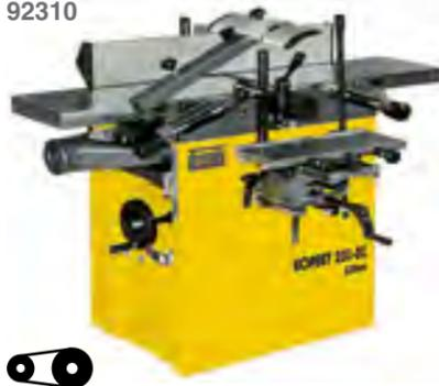
Жесткие и идеально точные рабочие столы имеют достаточно большую длину, что способствует выравниванию базовой поверхности заготовки. Четыре ножа на рабочем валу. Оригинальный механизм перемещения рабочего стола (режим рейсмуса) имеет повышенную надежность и фиксацию положения по высоте. В режиме строгания предусмотрено отключение протяжных роликов. Функция сверления и пазования.
