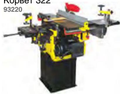
Функции станка: распиловка, строгание, рейсмус, сверление, фрезерование насадными и концевыми фрезами. Фрезерная головка и фрезерный патрон в комплекте. В режиме сверления заготовка крепится на рабочий стол, перемещаемый по трем осям. При распиловке используется подвижная каретка с прижимной струбциной и транспортным упором. Отключаемая автоподача рейсмуса. Нижний рабочий стол имеет два удлинителя. Предусмотрено подключение пылесоса.
