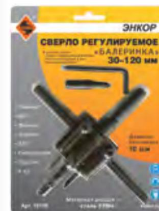
Сверло регулируемое «Балеринка» предназначено для высверливания круглых отверстий больших диаметров (30 - 120 мм) в таких материалах как ламинат, ДСП, фанера, дерево, ДВП, гипсокартон, пластик и др. В комплекте с «Балеринкой» идет шестигранный ключ для регулировки положения резцов относительно направляющего сверла и керн центрирующий. Материал резцов – сталь 65 Мн.
