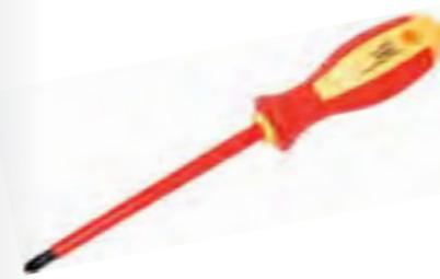
Изоляция отвертки гарантированно выдерживает напряжение 1000 вольт. Стержень отвертки изготовлен из хромо-ванадиевой стали и имеет намагниченный наконечник.
