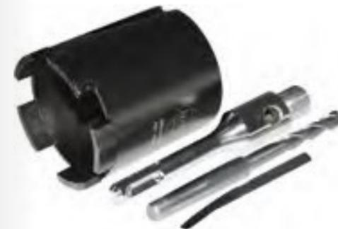
Сегментные алмазные коронки предназначены для безударного сверления отверстий в конструкциях, выполненных из кирпича, неармированного и слабоармированного бетона, без охлаждения.
