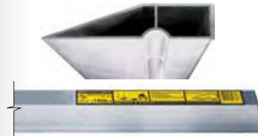
Правила выполнены из алюминия, профиль в виде прямой трапеции с радиусным рельефом на рабочей поверхности. Внутри профиля имеется ребро жесткости. Торцы правила закрыты пластиковыми заглушками.
