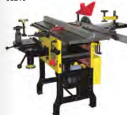
Функции станка: распиловка, строгание, рейсмус, сверлильно-долбежные операции, выборка пазов и снятие фасок насадными фрезами, заточка строгальных ножей. В режиме сверления заготовка крепится на рабочий стол, перемещаемый по трем осям. При распиловке используется подвижная каретка с прижимной струбциной и транспортным упором.
