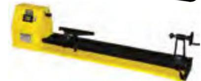
Станина станка выполнена из уголка и листовой стали, благодаря чему был снижен вес станка. Изменение скорости вращения шпинделя осуществляется перестановкой ремня.
